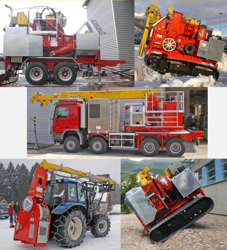
VALENTINI tiene una gama de modelos con 2 o 3 tambores, que pueden ser instalados sobre remolque, camión o orugas.
